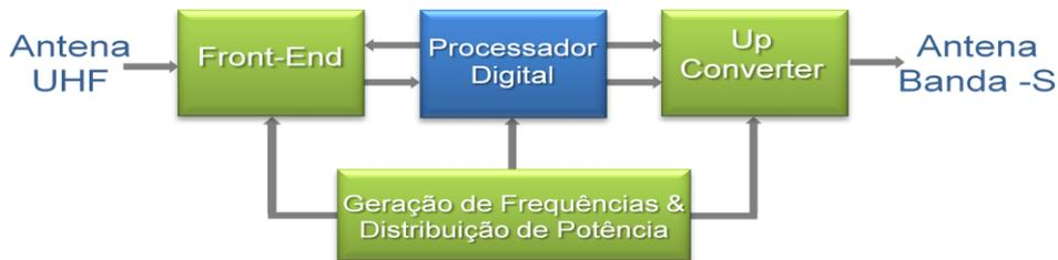
Figura 1: Diagrama em blocos do Transponder SBCDA
