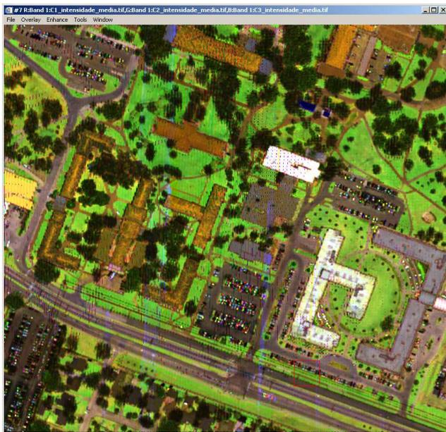
Figura 6. Composição em falsa cor da intensidade média de todos os pontos da nuvem de pontos LiDAR.
