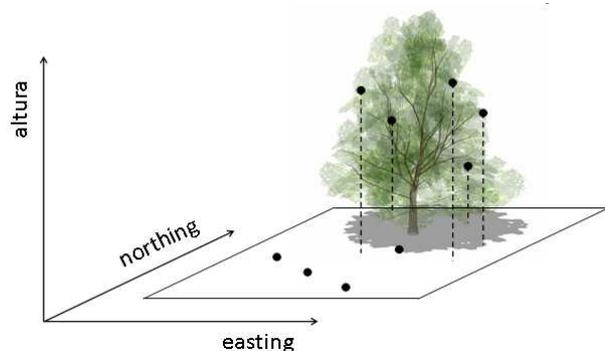
Figura 1. Pontos LiDAR numa célula UTM.
