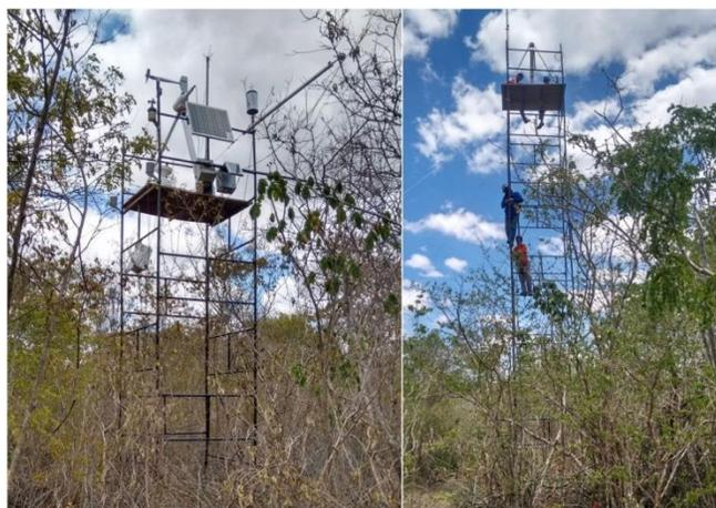
Figura 1. Torres onde estão instalados os sensores LAS (Fazenda experimental do INSA em Campina Grande-PB).
