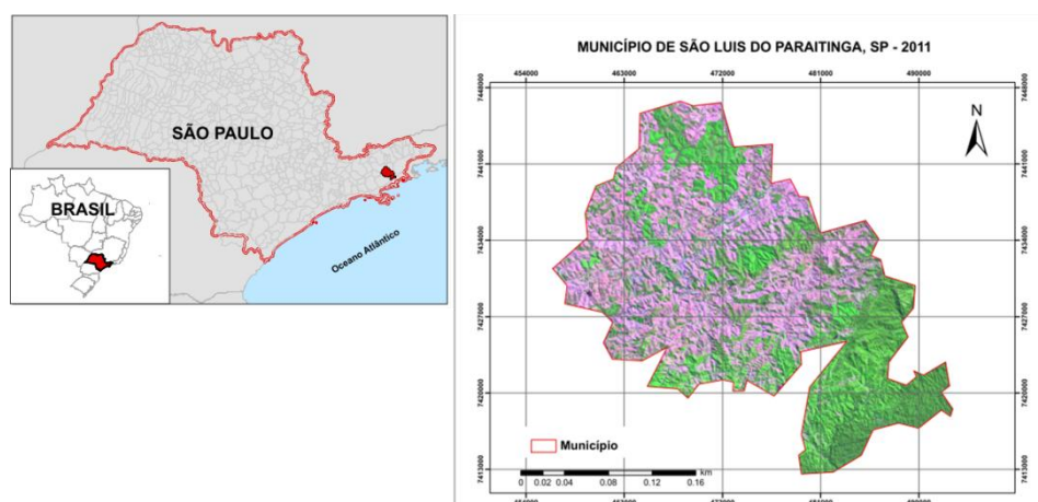
Figura 1. Representação da área de estudo por meio de composição colorida das bandas 5 (R) 4 (G) 3 (B) da imagem TM/Landsat-5 de 2011.
