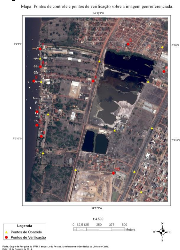
Figura 2: Detalhe da imagem utilizada e os pontos de controle e verificação.
