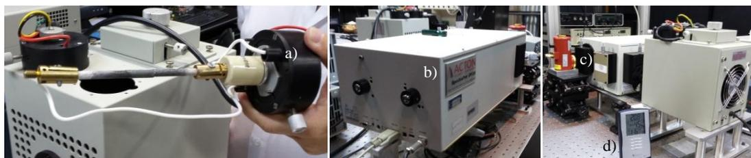
Figura 3. a) *Globar*; b) Monocromador; c) sensor de referência Judson; e d) termo-higromêtro. Fonte: os autores.
