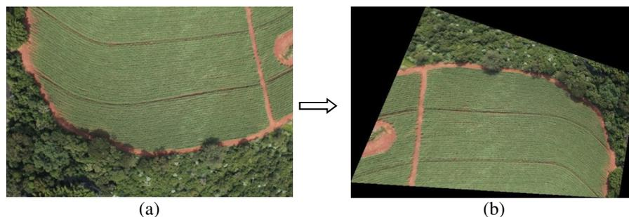
Figura 9. (a) Imagem IMG\_4742 original e (b) após correção da distorção projetiva.
