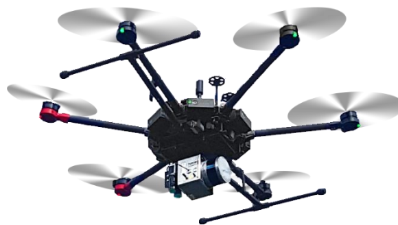
Figura 1. Sistema GatorEye ( http://www.speclab.org/gatoreye ). Drone: DJI Matrice 600 Pro hexacopter. Sensor Lidar: Phoenix VLP-16 (frequência de 300.000 pulsos/seg e até dois retornos por pulso).
