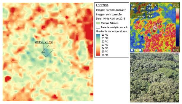
Figura 2. (Esq.) Imagem gerada pelo Landsat 7 sem correção atmosférica, com a localização do Parque Trianon e destaque para a área de medição dentro do parque. | (Sup. à dir.) Imagem termográfica do dossel na área de medição. | (Inf. à dir.) Imagem digital do dossel na área de medição.
