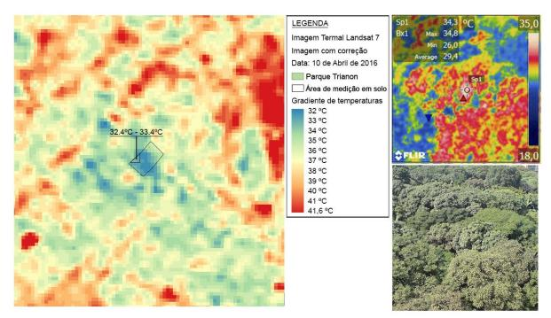
Figura 3. (Esq.) Imagem gerada pelo Landsat 7 tratada com correção atmosférica, com a localização do Parque Trianon e destaque para a área de medição dentro do parque. | (Sup. à dir.) Imagem termográfica do dossel na área de medição. | (Inf. à dir.) Imagem digital do dossel na área de medição.
