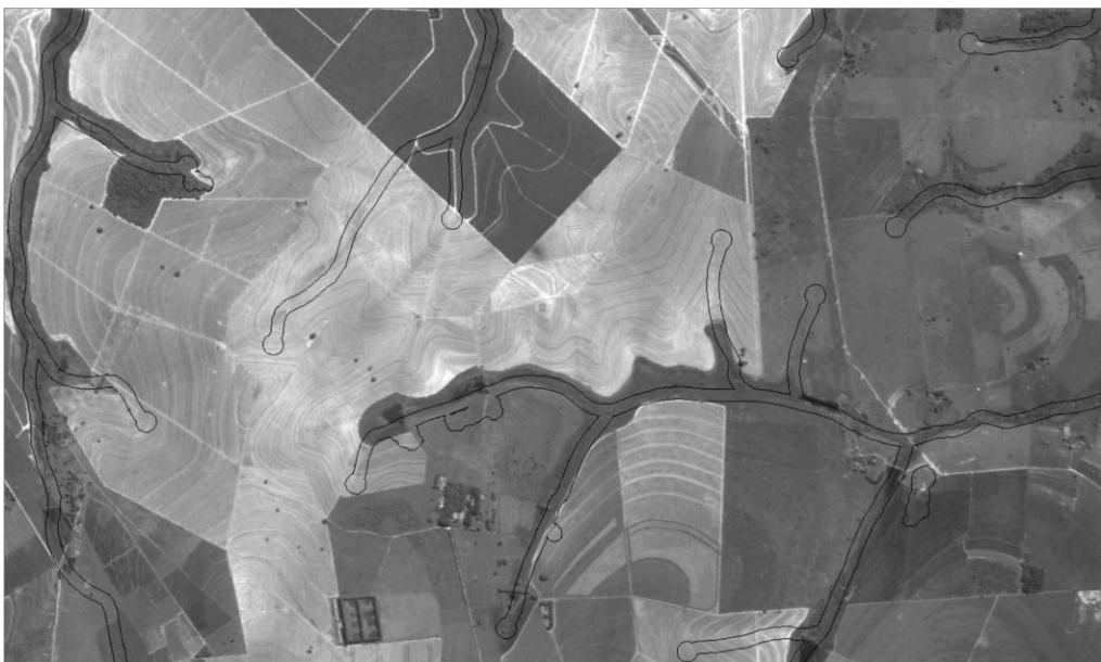
Figura 2.1. Imagem HRC e delimitação das áreas de preservação permanente, de acordo com as resoluções CONAMA.
