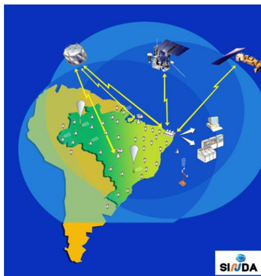
Figura 1 - Sistema Brasileiro de Coleta de Dados Ambientais, mostrando os círculos de visibilidade das estações de Cuiabá e de Alcântara.
