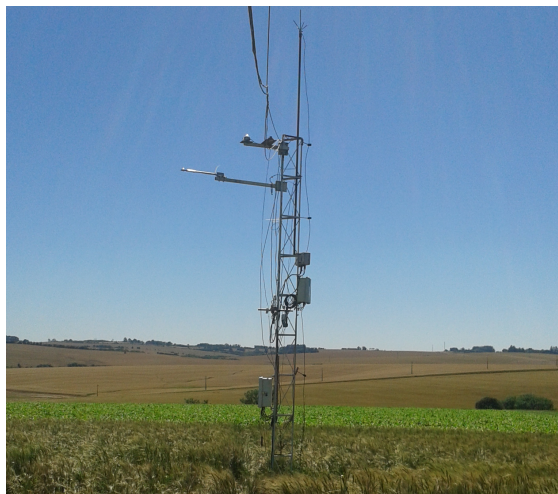
Figura 2. Torre micrometeorológica de monitoramento de fluxos e radiação.
