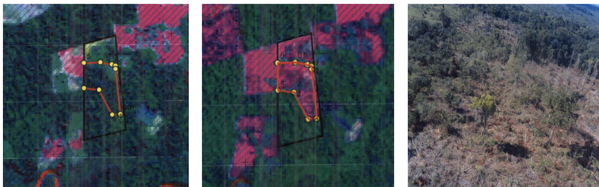
Figura 6. Confirmação em campo de um polígono localizado no município de São Félix do Xingu e mapeado como alteração. Datas de passagem das imagens T0 e T1: 20 de agosto de 2014 e 12 de setembro de 2014, respectivamente.
