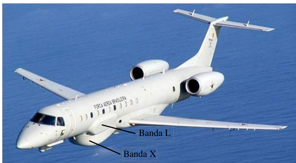
Figura 2. Sensores SAR, instalados na aeronave R-99. Divulgação/FAB.
