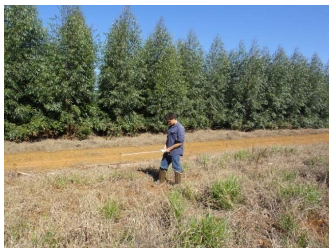
Figura 3. Uso do ceptômetro na coleta da radiação PAR incidente.
