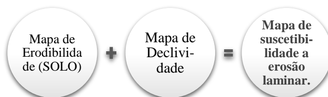
Figura 1. Etapas do procedimento metodológico para a definição das classes de suscetibilidade à erosão laminar.
