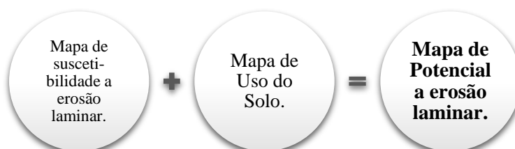
Figura 3. Etapas do procedimento metodológico para a definição das classes de Potencial à erosão laminar.
