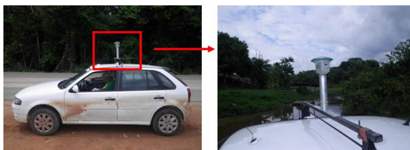
Figura 2. Ilustração do receptor acoplado ao veículo.
