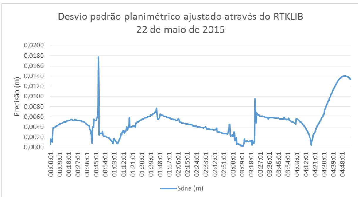
Gráfico 2 - Comparação do desvio padrão obtido no pós-processamentos dos dados ilustrando a variação das precisões planimétricas obtidas no levantamento realizado em 22 de maio de 2015, através do software RTKlib. Fonte - Elaborado pelo autor.
