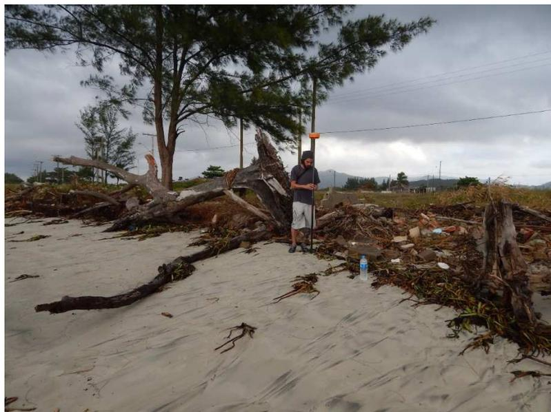
Figura 2 – Levantamento cinemático da linha de crista de praia com GPS Altus APS 3.
