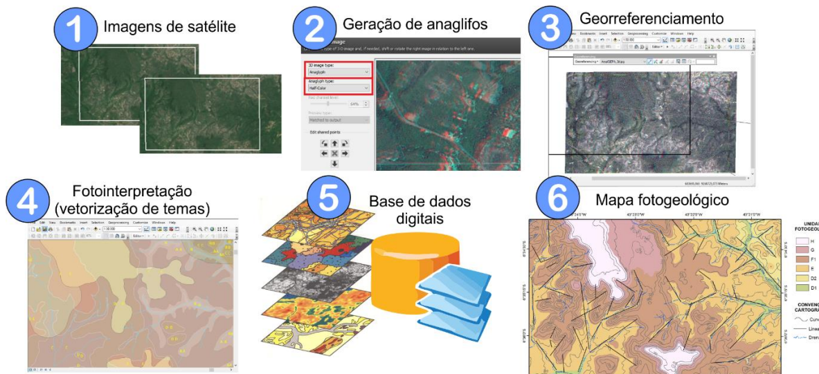
Figura 6 – Fluxograma com as principais etapas de produção de mapas fotointerpretados usando a combinação de estereoscopia digital de anaglifos gerados de imagens de satélite e SIG.
