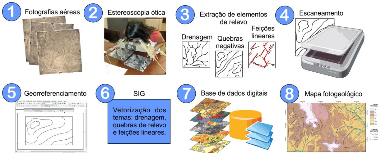
Figura 6 – Fluxograma com as principais etapas de produção de mapas fotointerpretados usando a combinação de estereoscopia ótica e SIG.
