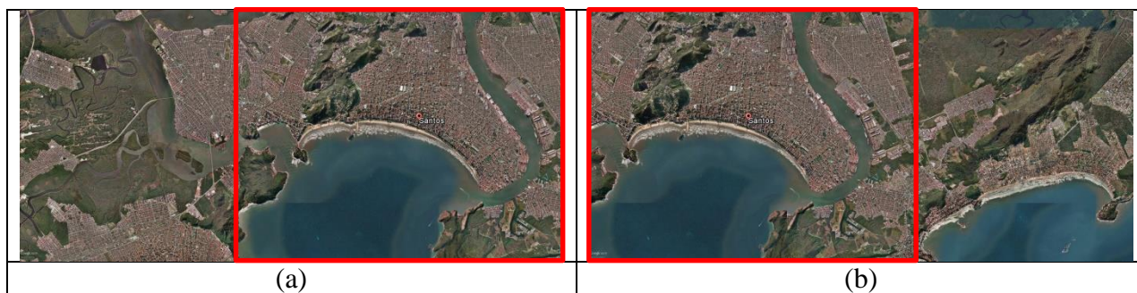
Figura 3 - Imagens capturadas para formar um par estereoscópio: (A) imagem esquerda; (B) imagem direita. A condição estereoscópica é conseguida com uma área de sobreposição entre as imagens, indicada pelo retângulo vermelho.
