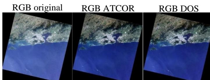
Figura 6: Comparação em RGB das imagens original e corrigidas pelos métodos ATCOR e DOS.
