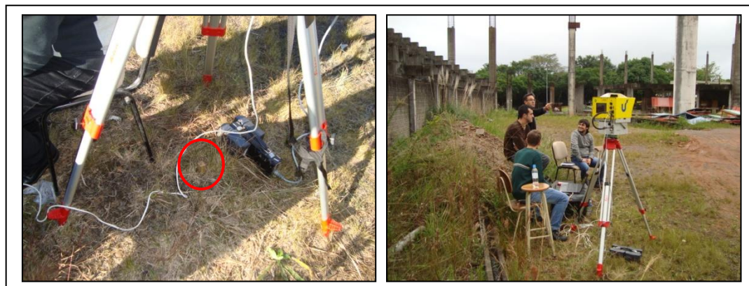
Figura 3 – Posição de Instalação do Laser Scanner Terrestre – Iris 3D
