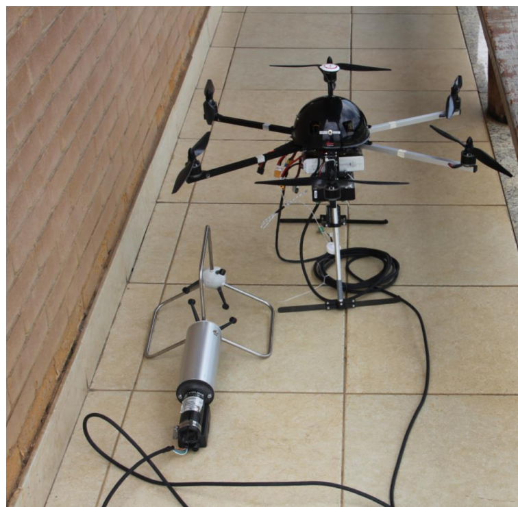
Figura 1 – Hexacóptero utilizado neste estudo e o anemômetro 3-D.
