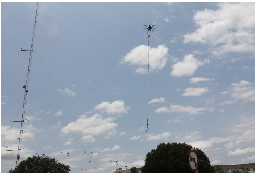
Figura 2 – Perfilamento do vento a partir do VANT próximo a torre anemométrica para fins de comparação.
