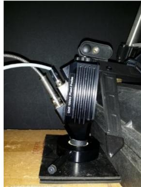
Figura 2. Sonda em contato com as amostras.
