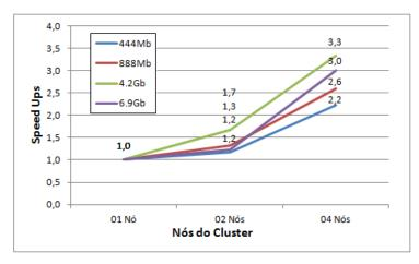
Figura 3 – Gráfico de *speedup* do classificador SVM para a base de dados Pavia.
