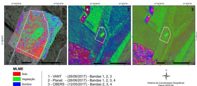
Figura 1. MLME para as imagens VANT (0,01 m) (1); PlanetScope (2) e CBERS4/Pan (3) em composição RGB para as frações solo, vegetação e sombra.
