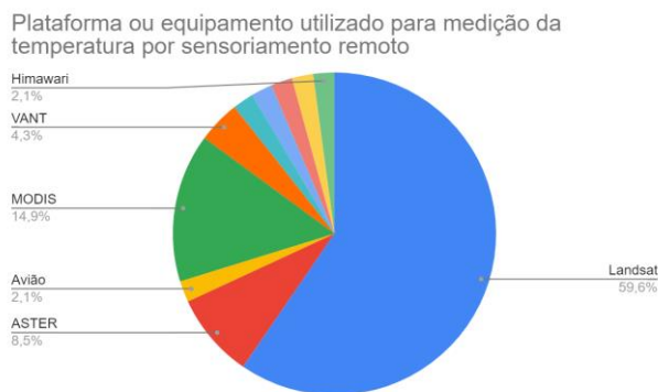
Figura 5 - Gráfico indicando as plataformas/equipamentos utilizados para obtenção da temperatura de superfície e a parcela de artigos que as utilizou. Fonte: Elaboração própria
