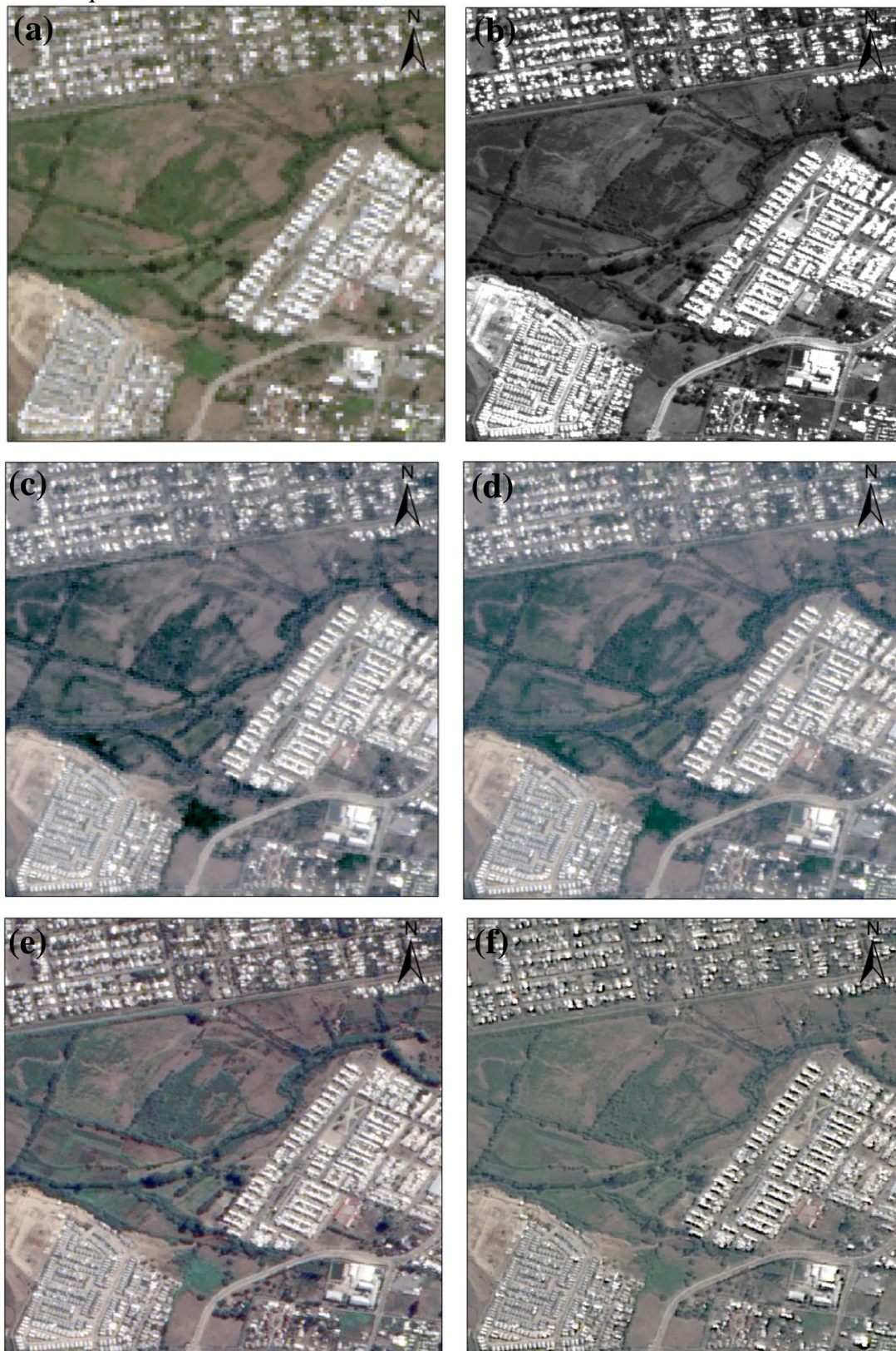
Figura 4: Em (a) imagem original multiespectral; (b) imagem pancromática; (c) imagem resultante fusionada pela técnica principal componente; (d) imagem resultante fusionada pela técnica Gram-Schmidt ; (e) imagem resultante fusionada pela técnica IHS (f) imagem resultante fusionada pela técnica HPF.
