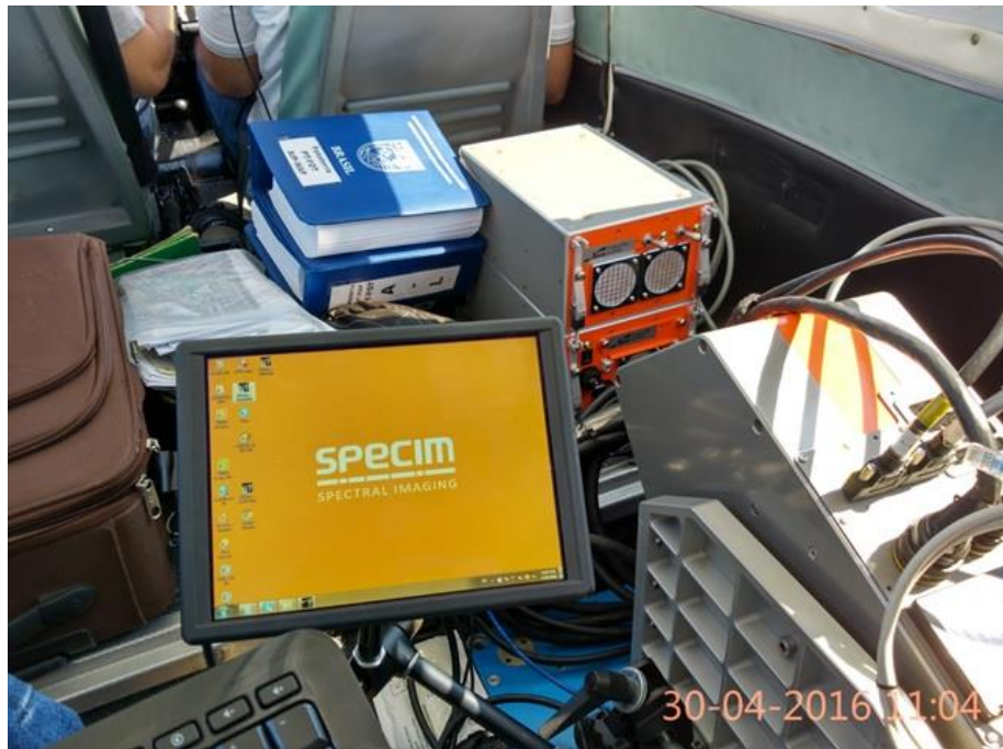
Figura 1. Sistema hiperespectral montado no avião para realizar o aerolevanteamento.
