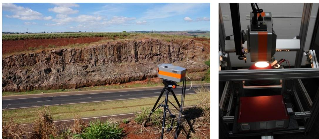
Figura 3. Sensor AisaFENIX, acoplado no tripé com sistema rotary, para aquisição de dados a campo (esquerda) e, Plataforma Single Core Scanner com o sensor AisaFENIX, para calibração e coleta de dados em laboratório (direita).
