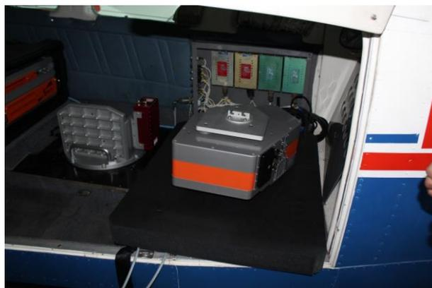
Figura 1. Sensor AisaFENIX sendo preparado para instalação em aeronave.
