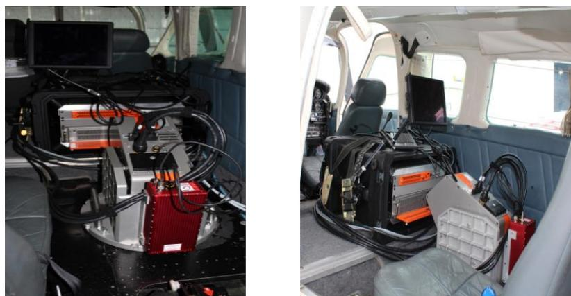
Figura 2. Sensor AisaFENIX instalado no avião, juntamente com o GPS/IMU modelo OXTS - RT3050
