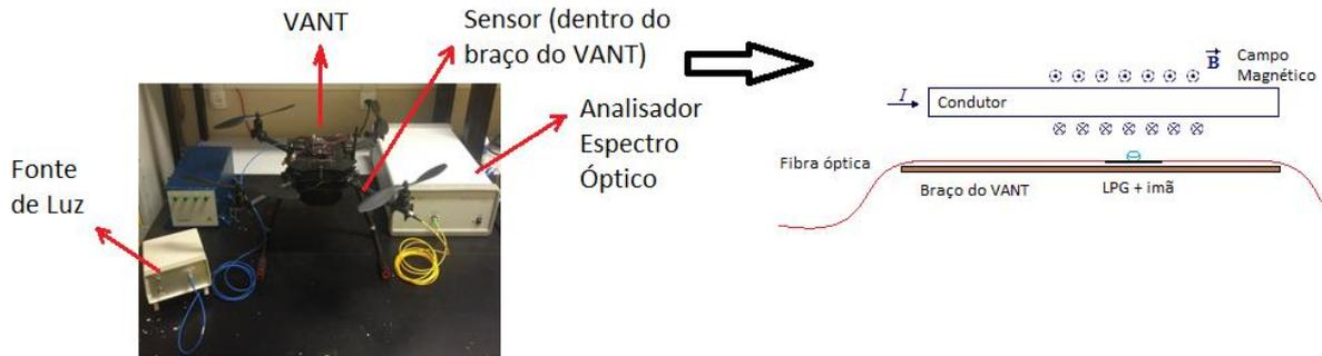
Figura 4 – Sistema de calibração e sensor óptico para a medida de corrente.
