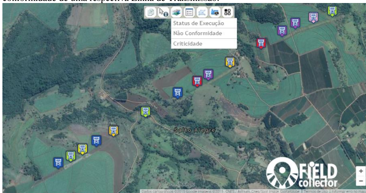
Figura 7. Exemplo de Mapa Temático gerado pelo Módulo Web – Espacialização dos tipos de não conformidades registradas ao longo de uma respectiva Linha de Transmissão.
