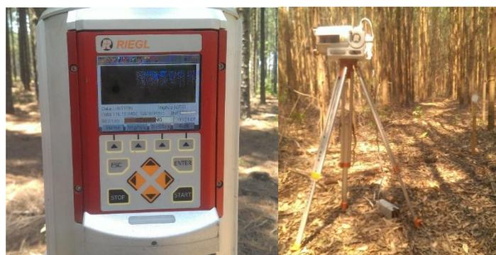
Figura 2: (esq.) Aparelho TLS RIEGL VZ-400, utilizado na geração de dados LiDAR neste trabalho. (dir.) Detalhes do RIEGL VZ-400 posicionado para realizar escaneamento da porção vertical da floresta.
