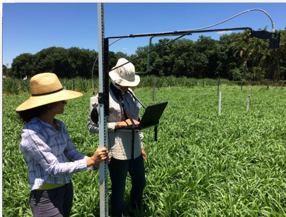
Figura 3. Fotografia da coleta de dados em campo, com o HandHeld 2Spectroradiometer .
