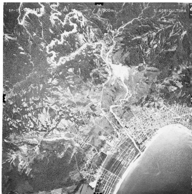
Figura 1. Fotografia aérea da VASP (1973) utilizada para delimitação das áreas de depósito de corridas de detritos do evento de 18/03/1967 em Caraguatatuba (SP).
