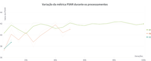
Figura 1 - Variação dos valores da métrica do PSNR dos processamentos DEM-ESRGAN executados (P7, P8 e P9) em função da progressão das épocas dos mesmos (onde k equivale a 1.000)
